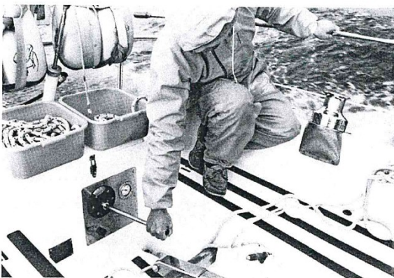
A 9.2.4-2 In dem Cockpit sitzt die Hydraulikpumpe für den dahinter sichtbaren Achterstagversteller. Der Druckanzeiger gibt Auskunft über die Belastung, die mit dem schwarzen Knopf des Entlastungsventils reduziert werden kann (Foto: Beilken).
