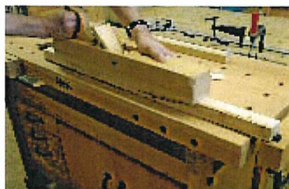
Zum Planhobeln (Abrichten) langer Flächen eignet sich die 600 mm lange Raubank. Dieser Hobel wird immer mit beiden Händen geführt. Eine Hand umklammert den Handgriff und schiebt, die andere drückt auf den vorderen Hobelkörper und zieht.
