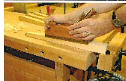
Schräge Tischbeine verputzen Sie mit einem fein eingestellten Putzhobel. Hobeln Sie möglichst immer in Faserichtung, in diesem Fall in Richtung Fußende, also zum sich verjüngenden Ende.
