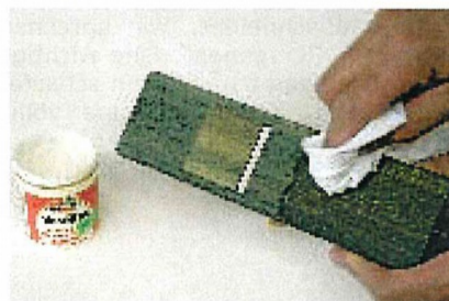
Die Hobelsohlen sind werksseitig plan geschliffen aber nicht behandelt. Zur Pflege der Sohlen hat es sich bewährt diese vor dem ersten Gebrauch gründlich mit Haushaltsvaseline einzureiben.
