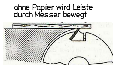
Bild 3 (a und b): Abnahmetisch auf Schneidenflugkreis mit der Papierprobe einstellen
