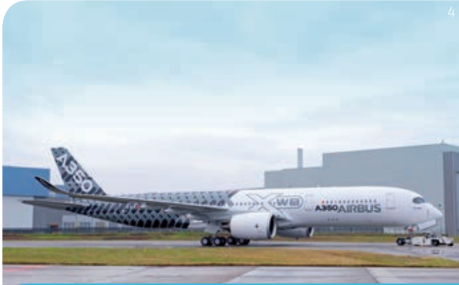
Luft- und Raumfahrt – Beispiel für Bauteil aus CFK: Rumpfschale des Airbus A350 XWB
