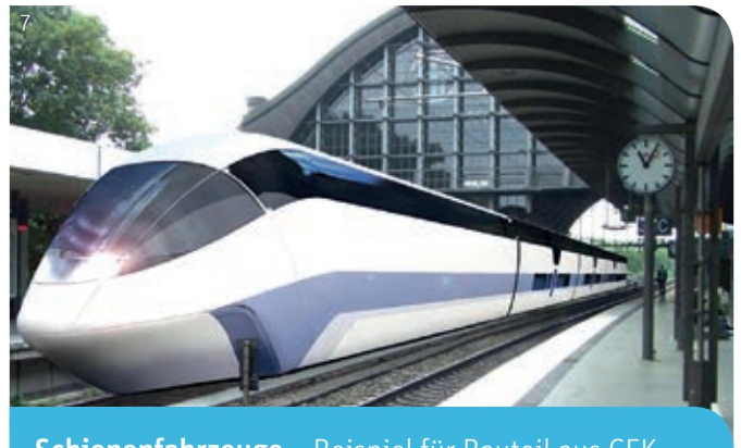
Schienenfahrzeuge – Beispiel für Bauteil aus CFK: Triebwagen-Kupplung, Zuganfang/-ende (Zugnasen), Fußboden
